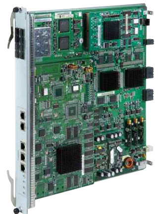
3Com Switch 8800 Firewall Module
